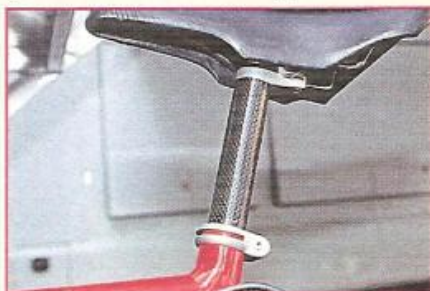
Gotti will es leicht: Die Karbon-Sattelstütze wurde auf seinen Wunsch verbaut, obwohl sie von Cannondale noch nicht getestet worden ist
