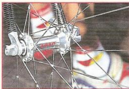
Die Coda-Nabe und die von 2,0 auf 1,5 Millimeter verjüngte DT-Revolution-Speichen, von Gerd Schraner zusammengebaut, gebunden und gelötet
